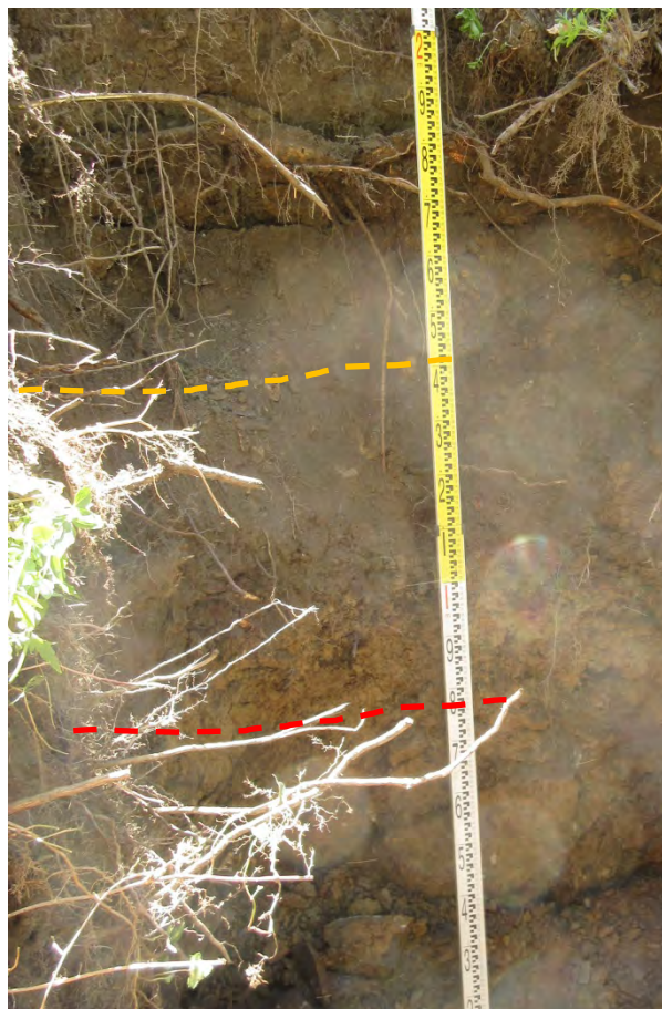
Foto 4: Baggerschlitz BS3 mit Grenze künstlicher Auffüllung und Hangschutt (gelb gestrichelt) und Mauerfundament (rot gestrichelt).
