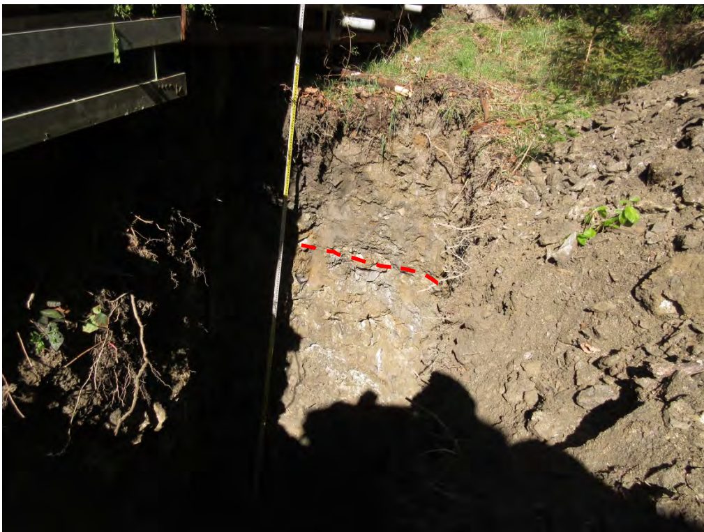
Foto 2: Baggerschlitz BS1 mit Grenze künstlicher Auffüllung und Hangschutt (gestrichelt).
