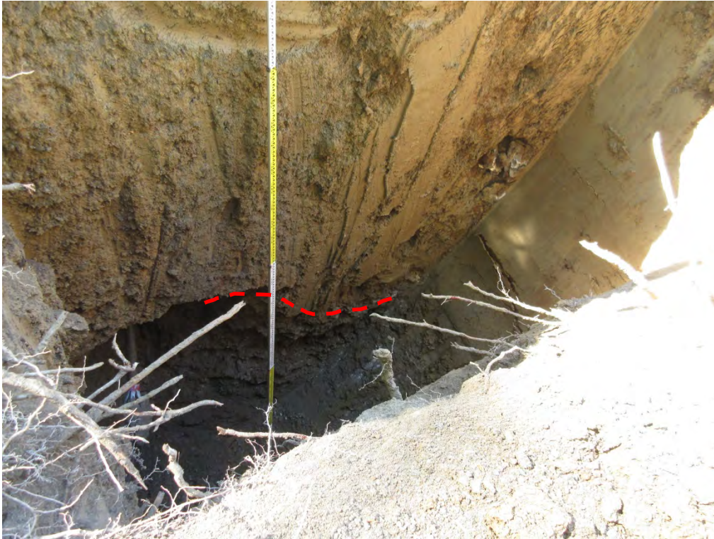
Foto 3: Baggerschlitz BS2 mit Grenze künstlicher Auffüllung und Hangschutt (gestrichelt).
